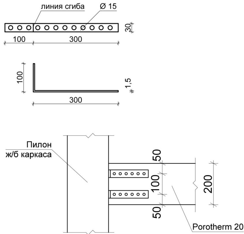
Крепление перегородок в верхней части к перекрытию, при пролете перекрытий более 3,5м, выполнять с зазором 20-30мм, который заполняется упругими проклаками. Кроме того, перегородки из Porotherm 8 и Porotherm 12 фиксируются к потолку при помощи металлических скоб размером 80x100мм, устанавливаемых с шагом 1,5м.
