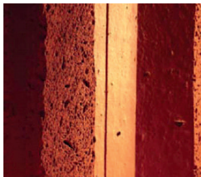
Рис. 6. Поризованная структура черепка
